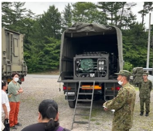
ろ過装置（海水以外の水を飲料用までろ過可能）
