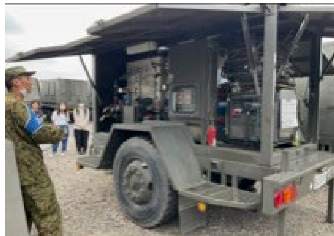
↑野外入浴セット (ボイラー、揚水ポンプ、発動電動機を搭載)
